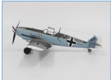
ミュージアムモデルも手掛ける、チェコのHpH Modelsより、1:18スケールのメッサーシュミットBf109Eが案内されました。全長約495mm、全幅約560mmの完成サイズで、胴体や主翼等がFRP製。細部にレジンパーツ、エッチングパーツ、塗装マスク、布製シートベルトとデカールが付属します。更に、主脚柱内に金属線を通して、着陸装置の強度も保っております。
