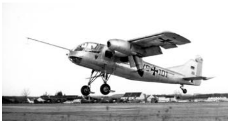
西ドイツの航空機メーカー、ドルニエ社がで製造したVTOLジェット輸送機の実験機
