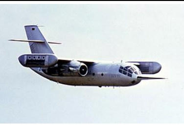
西ドイツの航空機メーカー、ドルニエ社がで製造したVTOLジェット輸送機の実験機
