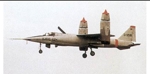
西ドイツのVTOLジェット戦闘機の実験機。
