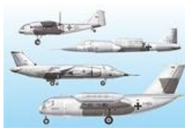
西ドイツの航空機メーカー、ドルニエ社がで製造したVTOLジェット輸送機の実験機
