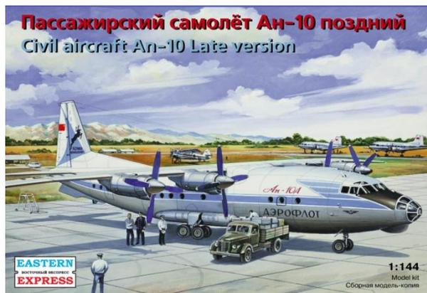
An-10は、双発機An-8の拡大発展型として開発され、1957年3月に初飛行に成功した。初期型は、横安定性不良改善のために水平尾翼両端に補助フィンを持つのが特徴で、1959年に路線就航し、108機が生産された。後期型では、旅客数を110名まで拡張したAn-10Aに発展し、水平尾翼両端の補助フィンが無くなり、かわりに胴体末尾下面にベントラル・フィンが追加された。
